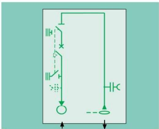
■ disposizione apparecchiature come da schema unifilare precedente, ma con l'utilizzo del QMT isolato SF6 anche per potenze superiori a 400KVA; (valutare gli ingombri, o passare a BM superiore)
