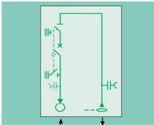
La soluzione **BM-DG3**, conforme ai "Criteri d'allacciamento degli utenti alla rete di media tensione" secondo **"ENEL Guida Connessioni Ed.VI-2021"** è costituita da:
